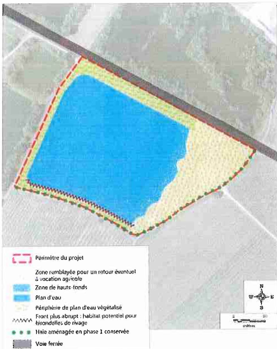
Fig 1 : Principe de remise en état – Carrière de la Plante des Meuniers – Saint-Même-Les-Carières
